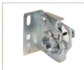
Paracadute molle (serie su tutti i portoni) Sistema di sicurezza che interviene bloccando la caduta del portone in caso di rottura dei cavetti di sollevamento.
