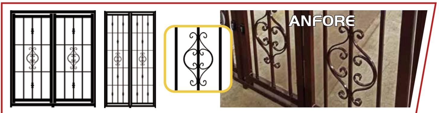
Realizzate con telaio ed **anta tubolare** in acciaio zincato **40x30** da 20/10. Specchiature realizzate in **acciaio zincato pieno**, tondo da diam. 16 infilato in barra forgiata asolata da **16 mm**. decori ornamentali zincati a seconda della tipologia.
