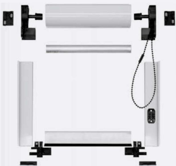
Zanzariera ad avvolgimento verticale con comando a catena posta sul lato del cassonetto, con rete saldata con bottoncini laterali, ideale per finestre e portefinestre, disponibile solo con cassonetto da 50 mm con rete in fibra di colore grigio. Possibilità di realizzazione anche con tessuti oscuranti o fil-tranti, inoltre per le portefinestre è possibile richiedere il comando della catena anche all'esterno per richiudere la zanzariera dopo il passaggio.
